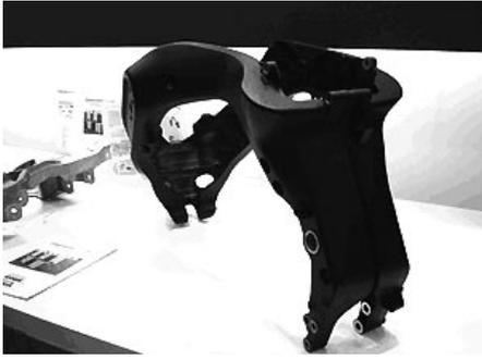
写真22 車体フレーム(Dubai Aluminium)
