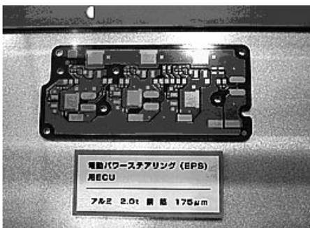
写真19 アルミベースプリント配線板
