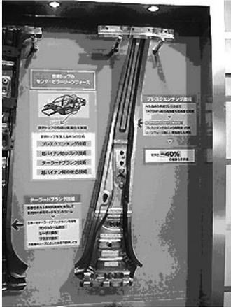
写真31 センターピラー(豊田鉄工)
