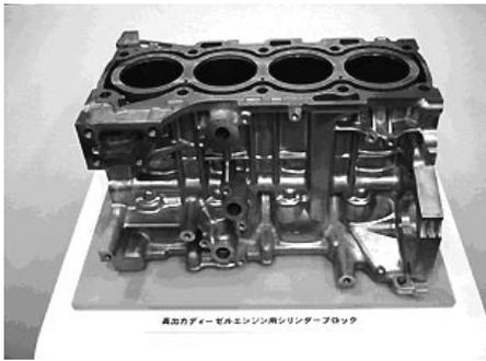
写真10 シリンダブロック(豊田自動織機)
