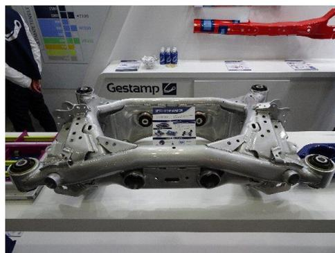
写真 4 アルミ製シャシサブフレーム
