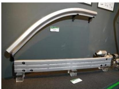
写真35 STAF®工法Aピラー (開発品)
