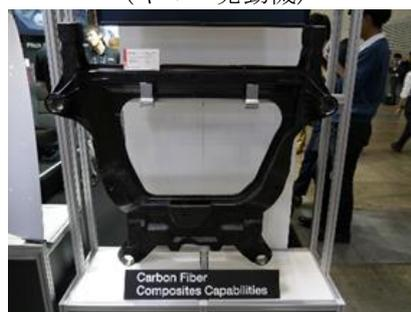
写真30 軽量化複合材料-フロントサブフレーム (開発品) (マグナ・インターナショナル・ジャパン)
