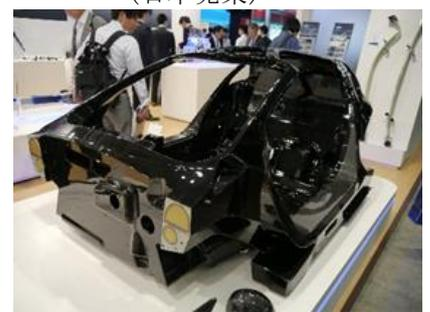
写真31 RTM成形によるCFRP製モノコック (ムベア・ジャパン)
