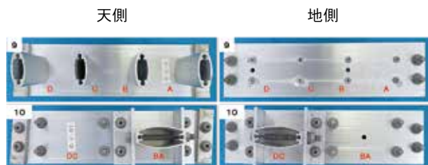
A：ジオメット処理 B：ジオメット処理＋水抜き穴 C：無処理 D：無処理＋水抜き穴 A B：上向きジオメット処理＋水抜き C D：下向きジオメット処理
