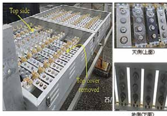
（b）軒天暴露試験（蓋を取って撮影）
