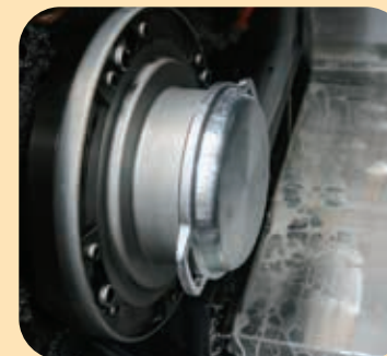
蓋も、鋳造した後 切削加工し、研磨する。
