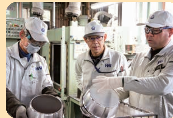
本体は切削加工した後、底にIH対応用の鉄を溶着し、塗装、研磨する。
