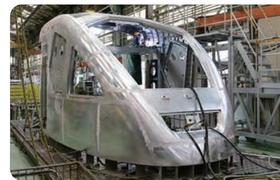
三次元削り出し加工のアルミ板を溶接して製造した流線型先頭部。内側には補強を施し、安全性を確保している。
