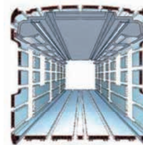
車両はオールアルミダブルスキン構造。断熱性や静音性、振動抑制に優れている。
