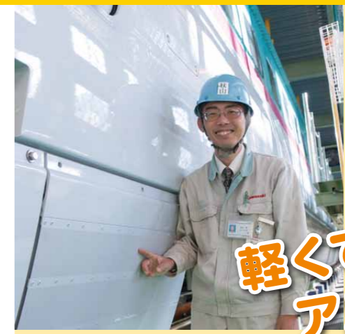
東北新幹線E5系車両。アルミ製吸音パネルは車両の側面下部に取り付けられる。
