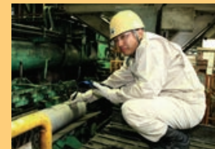
ビレットの温度は押出時の摩擦熱を考慮して、先端から末端にかけて温度勾配がつけられている。そのため部位ごとに温度を細かくチェックしている。
