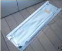
水蓄熱式床暖房システムのユニット。これが2階床下に敷き詰められ、家全体には約5トンの水が使われる。
