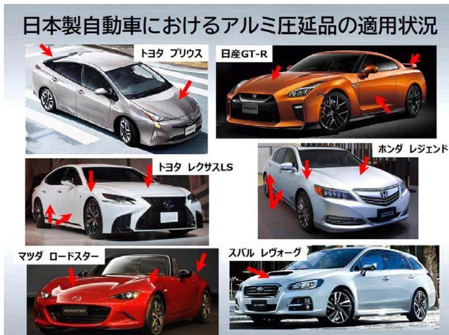
自動車には、以前からエンジン回り、ラジエータ等にアルミニウムが使用されてきている。最近では、写真の例のように外板(パネル)にアルミニウムの板材を使用する例が増えている。自動車 1 台当たりの平均的なアルミニウムの使用量は、1999 年は 112kg、2019 年は 172kg であり、この 20 年で 1.5 倍となっている。
