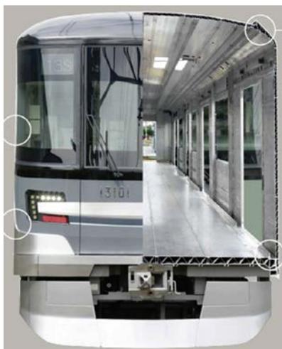
写真は、東京メトロ日比谷線で使用されている最新の車両(13000 系)。2017 年に使用開始、設計最高速度: 110km/h。強度を保ちつつ軽量化を図るため、ダブルスキン構造となっている。アルミニウムの高度な押出技術により製造された。東京メトロは、全車両 2,716 台 (2020 年 3 月末現在)でアルミ製の車両を使用している。アルミ合金の種類を極力統一し、リサイクル性を向上するとともに、車体の軽量化により、走行時のエネルギー使用量の削減に寄与している。
