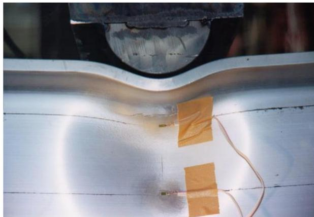
図3.4 丸鋼による試験体の変形
