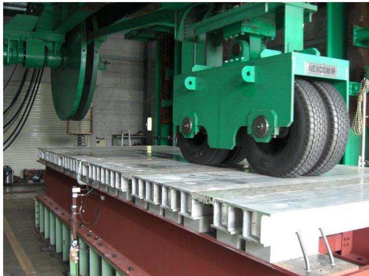
図 1.3 道路橋用アルミニウム床版のトラックタイヤ移動載荷疲労試験
