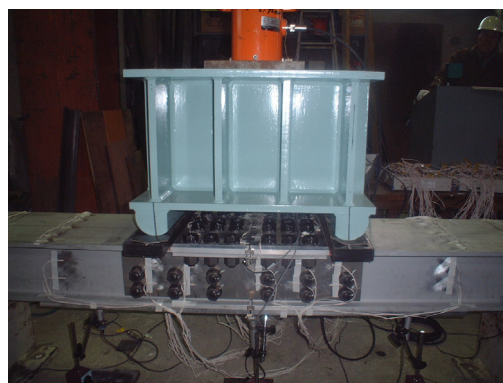
(b) 部材端継手試験体
