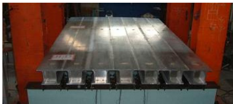
図1 開閉断面のアルミニウム床版
