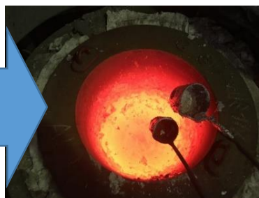
溶解後、アルミを型枠へ流し込む。
