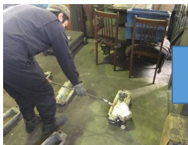
溶解後、アルミを型枠へ流し込む。
