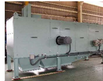
磁気選別装置 （鉄を除去）
