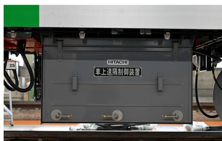
車上遠隔制御装置
