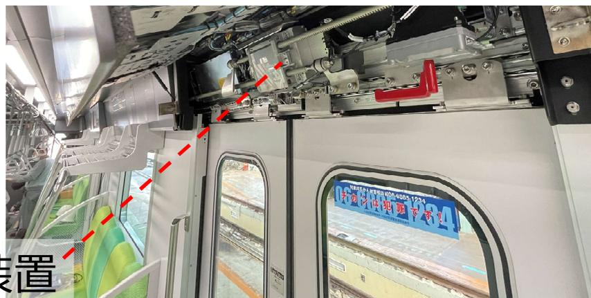
戸閉装置を傾けて設置し、カット形状によるスペース制約を解消。
