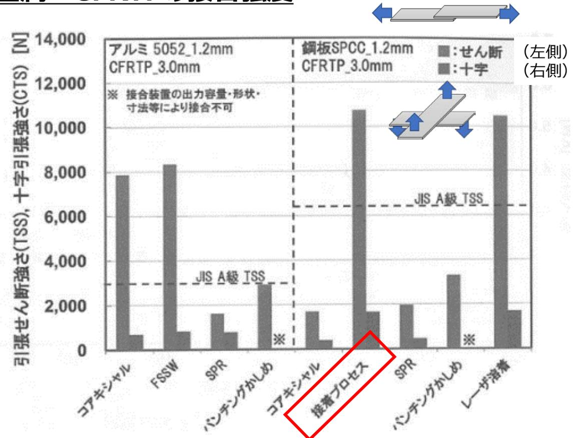
接合面積が大きく応力集中の緩和により、剛性や衝突エネルギー吸収性が向上する
