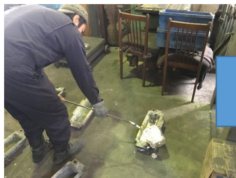
溶解後、アルミを型枠へ流し込む。
