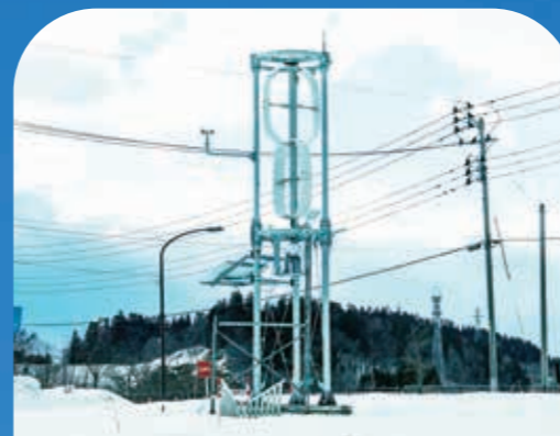
開発中の風力発電機。アスター発電機が微風でも回転し、電気を生み出す。コンパクトな躯体は運搬・設置・保守性に優れ、災害時にも頼れる存在に。
