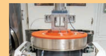
アルミダイキャストのボディが並ぶ製品検査エリア(上)。信頼性評価には振動試験機(下)などを活用する。
