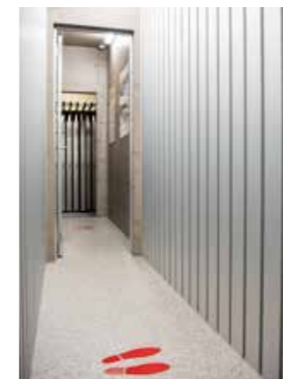
吸音機能付仕上材の実験ブース。足跡マークに立ち声を出したり手を叩いたりすると、仕上材のある場所(手前)とない場所(奥)では音の響き方が違うのがよくわかる。
