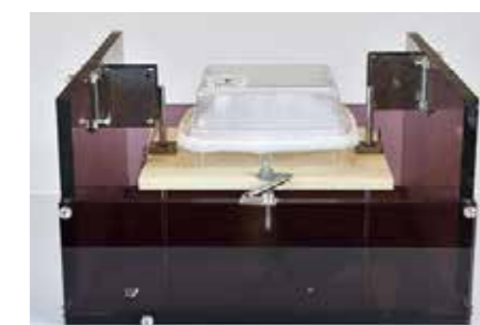
免振装置:衝撃に弱い動物の受精卵などの輸送にも最適
