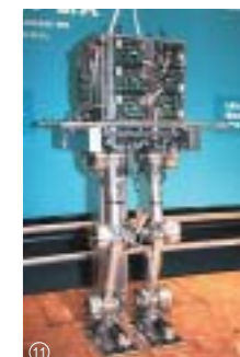
試作機の脚部には押出成形材やダイキャストなどが使われている(E6試作機)
