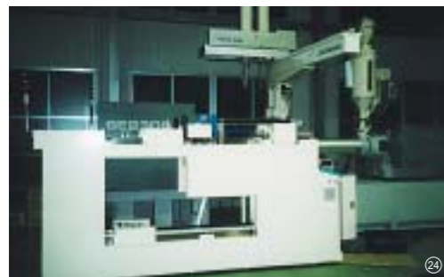
②4 正確に効率よく射出成形品を扱うロボットではフレームなどにアルミを使用
