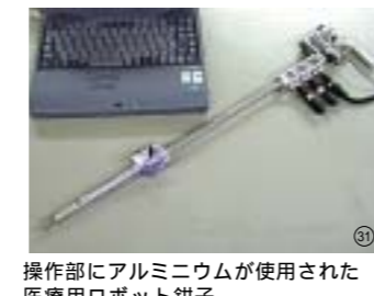
③1 操作部にアルミニウムが使用された医療用ロボット鉗子
