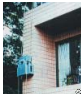
②8 建築物の壁面を点検する外壁自動調査機ロボットのケースはアルミ製
