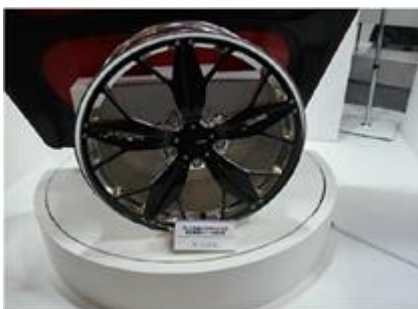
写真 22 アルミ合金とCFRP とによる複合構造ホイール試作品 (三菱レイヨン)
