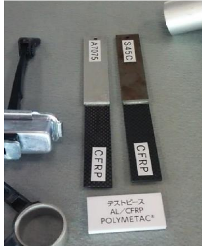
写真 20 テストピース AL/CFRP (三井化学)
