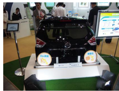
写真 14 樹脂製バックドア (三菱重工業プラスチックテクノロジー)
