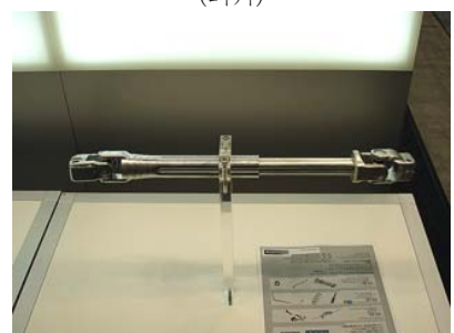
写真21 中間シャフト (ThyssenKrupp)
