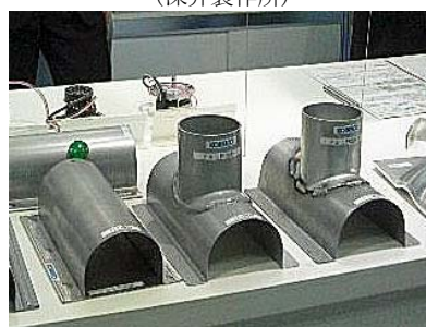
写真20 FCW異材接合品 (神戸製鋼)
