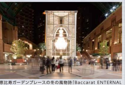
恵比寿ガーデンプレースの冬の風物詩「Baccarat INTERNAL LIGHTS2006~2007」が行なわれ、パカラのシャンデリアを覆うショーケースがアルミ部材(十字形押出形材ユニットを組み合わせたラッシュパネル)で製作されました。その後の「Baccarat INTERNAL LIGHTS2014-2015」まで計8回のリユースで、このショーケースが組み立てられアルミの優位性が証明されました。そして最後までその美しさは失われる事がありませんでした。
