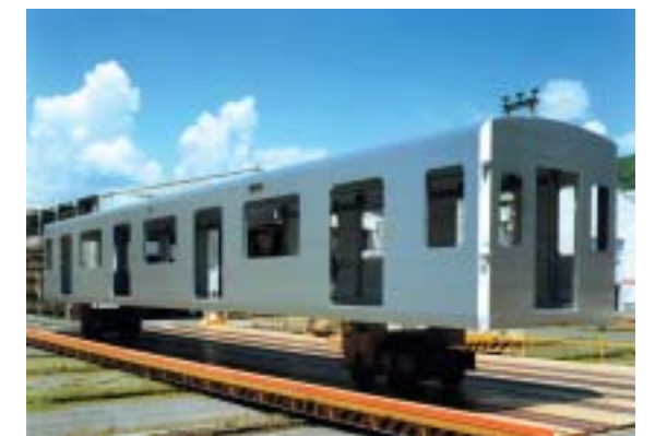
摩擦攪拌接合による構体外観(東京地下鉄05系13次車)
