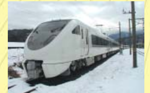
JR西日本 683系 特急形交直流電車 ダブルスキン押出型材構体、ミグアーク溶接・FSW
