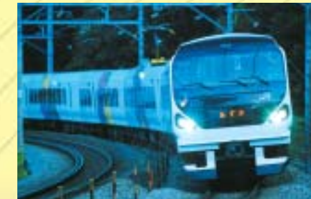
JR東日本 E257系 特急形直流電車 ダブルスキン押出型材構体、ミグアーク溶接・FSW
