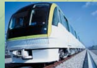
福岡市交通局 3000系 リニア駆動方式地下鉄 ダブルスキン押出型材構体、FSW
