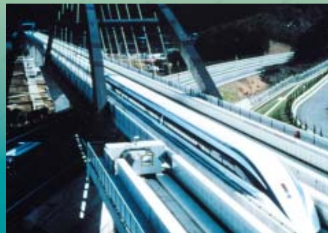
浮上式鉄道(山梨実験線) MLX01 超電導磁気浮上式リニアモーターカー シングルスキン押出型材構体、FSW
