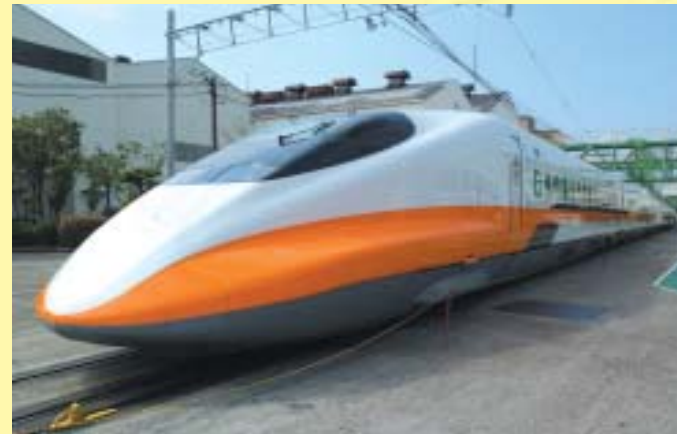
台湾新幹線 700T系 700系を基本とした初の輸出新幹線車両 ダブルスキン押出型材構体、ミグアーク溶接
