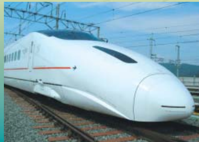
JR九州 800系 700系新幹線を基本とし、格調の高い内装設備 ダブルスキン押出型材構体、ミグアーク溶接
