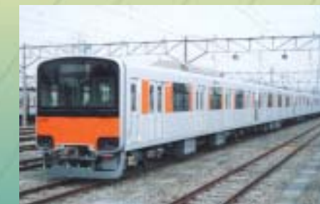
東武 50000系 新型通勤電車 ダブルスキン押出型材構体、FSW
