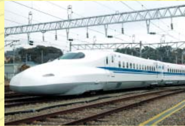
JR東海・JR西日本 N700系 新ATCシステム・車体傾斜方式等を採用 ダブルスキン押出型材構体、ミグアーク溶接・FSW
