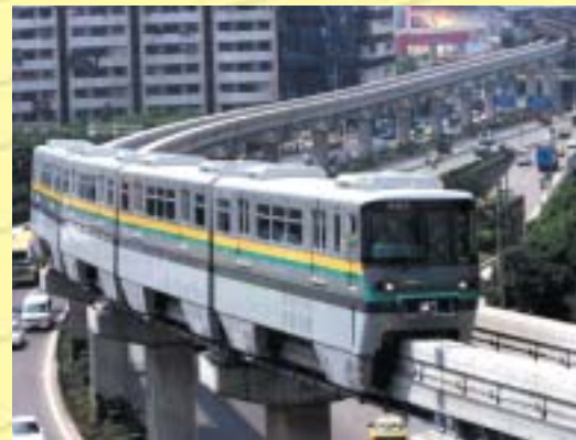
中国・重慶モノレール 跨座式モノレール シングルスキン押出型材構体、ミグアーク溶接
