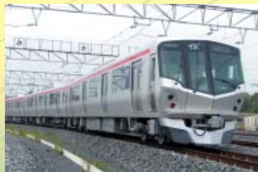
首都圏新都市鉄道 “つくばエクスプレス” TX-1000系直流電車、TX-2000系交直流電車 ダブルスキン押出型材構体、FSW
