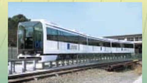
愛知高速 HSST100形“リニモ” 磁気吸引浮上・リニア誘導モータ推進式 シングルスキン押出型材構体、ミグアーク溶接
