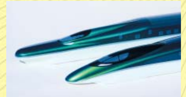
JR東日本 新幹線高速試験電車FASTECH360S 最高速度360km/h営業運転を目指す高速試験電車 E954形式新幹線専用 ダブルスキン押出型材構体、ミグアーク溶接・FSW
