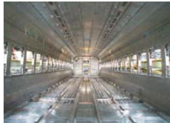
700系新幹線車両の構体内部 3)
