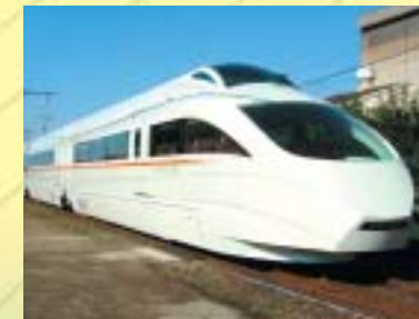
小田急 50000形 特急形直流電車 ダブルスキン押出型材構体、ミグアーク溶接
