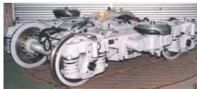
⑨ 振動を抑える新型台車はアルミ部品の多用により軽量化されている
