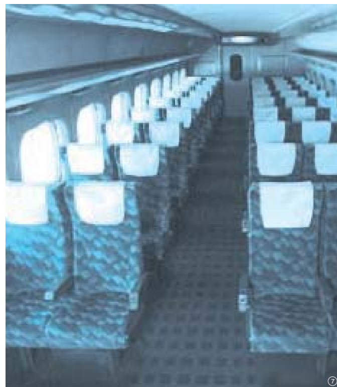
⑦ 広々とした客室内では壁面パネル、天井パネル、荷物棚などがアルミ製
