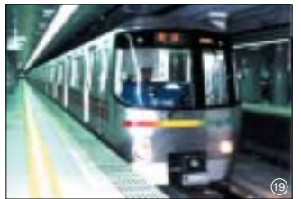
東京都営地下鉄12-000形車両。リニアモーター駆動の小型アルミ車両で、外板は無塗装仕上げ
