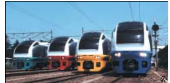
常磐線「フレッシュひたち」のE653系車両。在来線で初めてのアルミ中空大型押出型材のダブルスキン構造を採用
