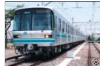
営団地下鉄南北線9000系車両。製造の合理化、品質の安定などのため中空大型押出型材を採用
