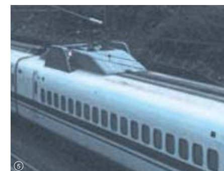
風の抵抗を減らすためシングルアーム化し、小型化したパンタグラフ。カバーはリサイクルを考慮してアルミを使用
