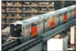
多摩都市モノレール1000系車両。薄肉大型型材などを用いて軽量化、構造簡略化が図られた
