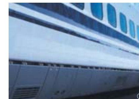
電気機器などが取り付けられている床下部ではふさぎ板や配管にアルミを使用
