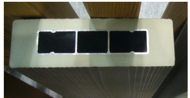
建材としての強度の確保はアルミ押出型材 A6063
