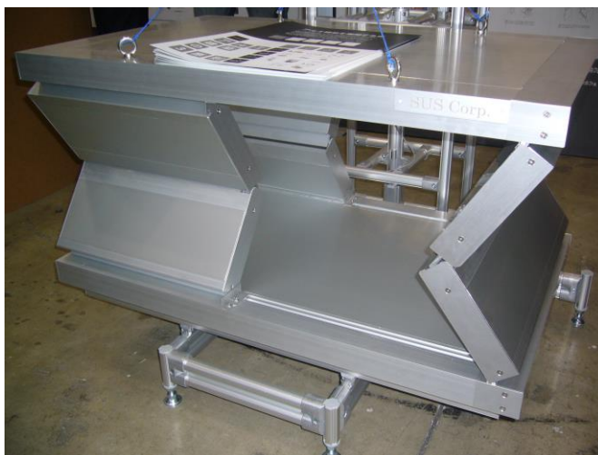
トラッククレーンで屋根パネルを吊り上げる動き再現し、ヒンジパネル構造を見せていた スケール 1/4 スケールモデル (株SUS)
