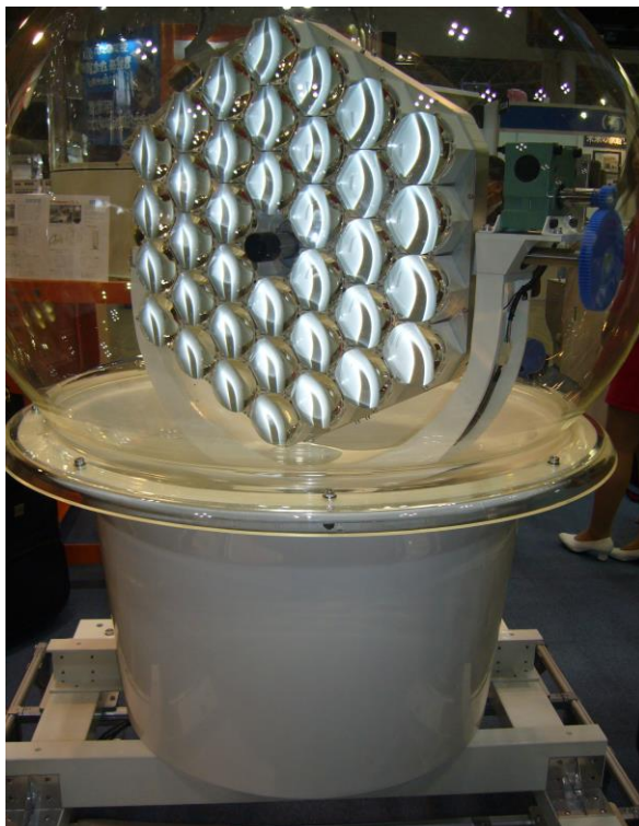
太陽位置検出用光センサーで1日安定した採光が可能 (レンズ集光+光ファイバー伝達方式)
