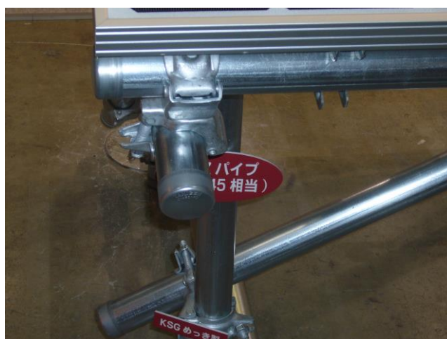
本体の太陽光パネルに比べ パイプ、クランプ(継手部)がごつすぎる
